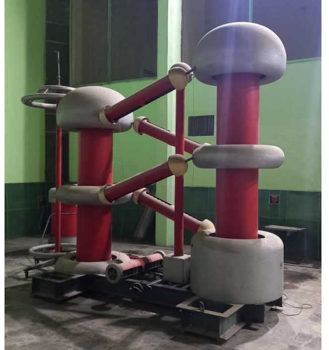
مولد توتر عالي مستمر مرحلتين بخرج 600kv
